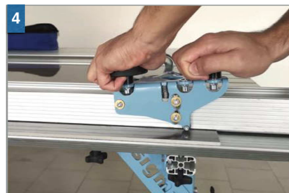
4 Incidere per 3/4cm indietro l'estremità della lastra dall'interno verso l'esterno, successivamente inciderla per tutta la lunghezza mantenendo la pressione di spinta costante. Score the end of the tile 3/4cm back from the inside to outside, then score it along its entire length while maintaining a constant pressure.
