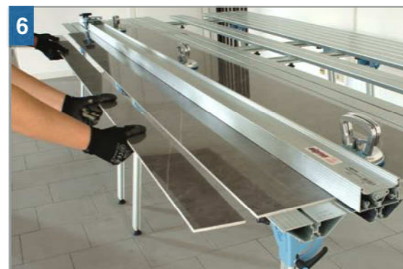
6 Completare lo spacco premendo delicatamente verso il basso. Complete the snap by pressing gently downwards.
