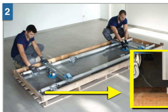
2 Adattare il telaio alla lastra e distribuire le ventose in maniera omogenea, mettere in depressione le ventose, posizionando i piedi in gomma fuori dalla lastra. Adapt the frame to the tile and distribute the suction cups evenly, applying firm pressure downwards whilst closing the cup. Place the rubber feet out of the tile.
