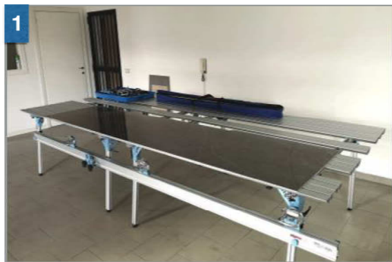
1 Posizionare la lastra sul banco da lavoro. Place the tile on the workbench.
